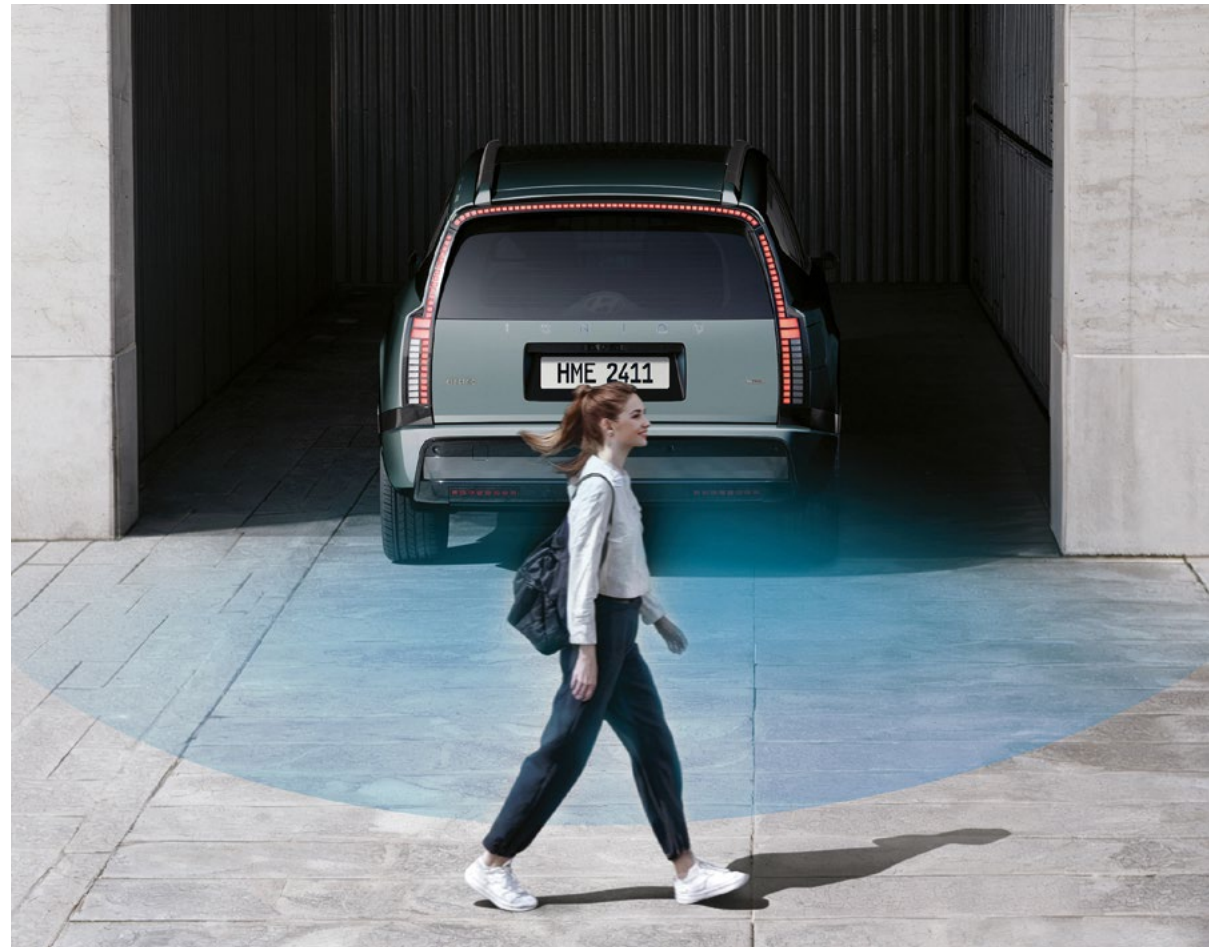
PCA (Parking Collision-Avoidance Assist) Ostrzega i hamuje przy wykryciu przeszkody podczas parkowania przodem lub tyłem.
